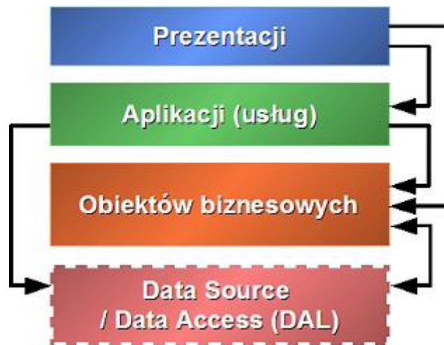
Rys. 3.2. System z wyodrębnioną warstwą usług
